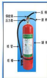
注：除酸碱式灭火器外，其他灭火器使用时不能颠倒，也不能横卧，否则灭火剂不会喷出。
