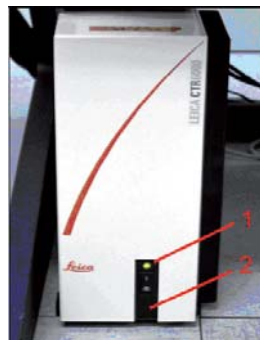
图 1-2 显微镜电源(1.指示灯；2.电源开关)
